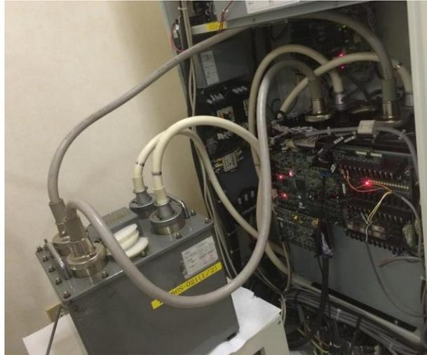
図 8-(b) X線高電圧発生装置-分圧タンク接続
