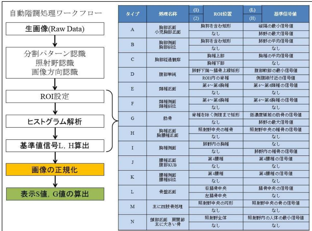
図 37 自動階調処理フローと 14 種類の ROI の設定
