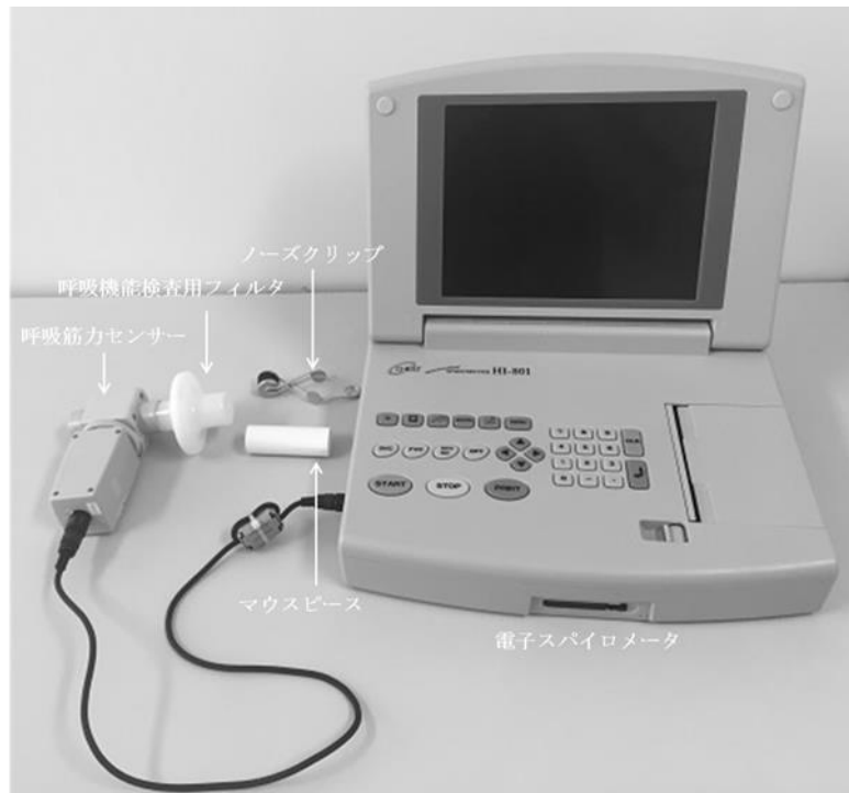
図 5. 電子スパイロメータおよび周辺機器
