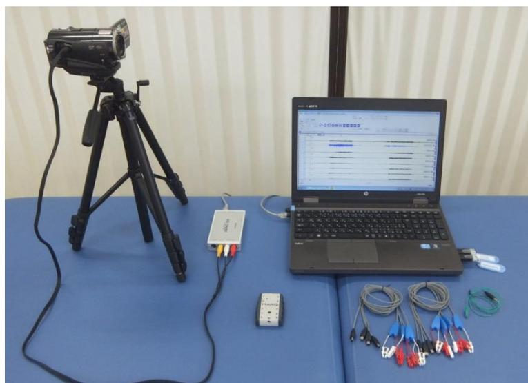
図 10 表面筋電計装置(テレメトリー筋電計 MQ16)
