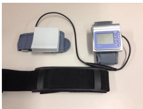
図 1-1. 使用したハンドヘルドダイナモメーターと固定用ベルト
