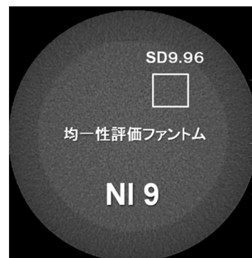
図5 NI (Noise Index) と画像 SD の関係 水ファントムのような密度が均一の物体における撮影時の NI (Noise Index) は、関心領域の画像 SD と近い値になる。図は、NI 9 で均一性評価ファントムを撮影し関心領域の画像 SD を計測した画像である。画像 SD は 9.96 であり NI と近い値なる。
