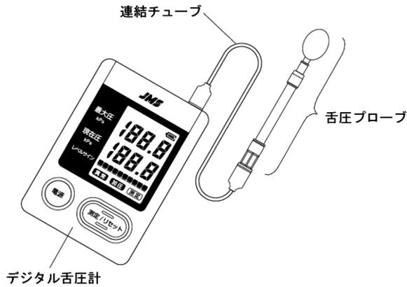
図1 バルーン型舌圧測定器「舌圧測定器(TPM-01型, JMS社)」(JMS舌圧測定器 添付文書より引用)
