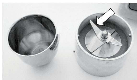
図1 錠剤粉砕機の内部
